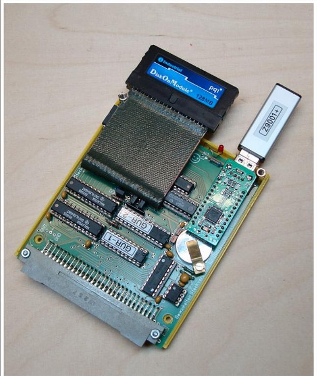
Die Hilfsplatine (Uni-Streifenplatine) hat BE-seitig „Fädeldrähte“ für die zweite Reihe (mit Klebeband abgedeckt).
